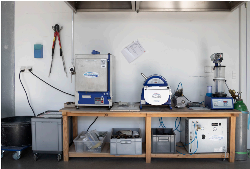
Giessanlage komplett. v. l. n. r: Wasserbecken, Einbettmasse, Brennofen, Giessanlage, Vakuumpumpe, Kühlwasser, Einbettanlage, Argon
