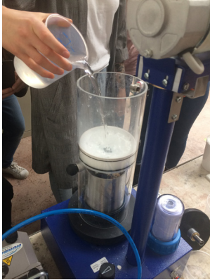
2. Wasser einfüllen (500ml / 22°)
