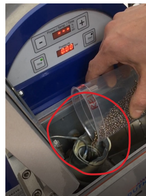
3. Metall in Tiegel füllen
