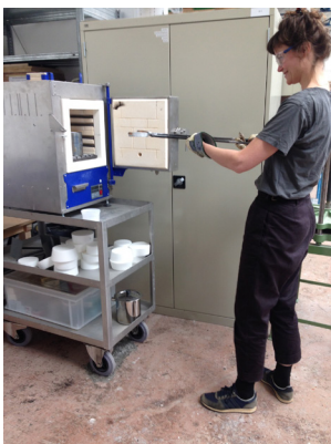
5. Küvette bei 600° aus dem Ofen nehmen
