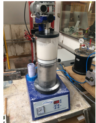
7. Mischwerk 4 min einschalten
