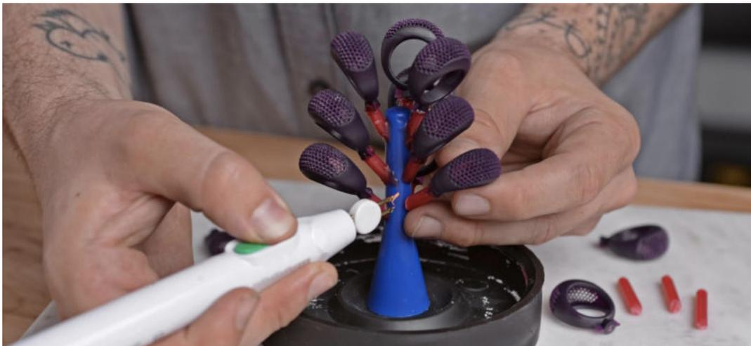
Bringen Sie Gusskanäle und Angüsse am Modell an (bei Druckteilen aus Castable Wax Resin V1 und darüber).
