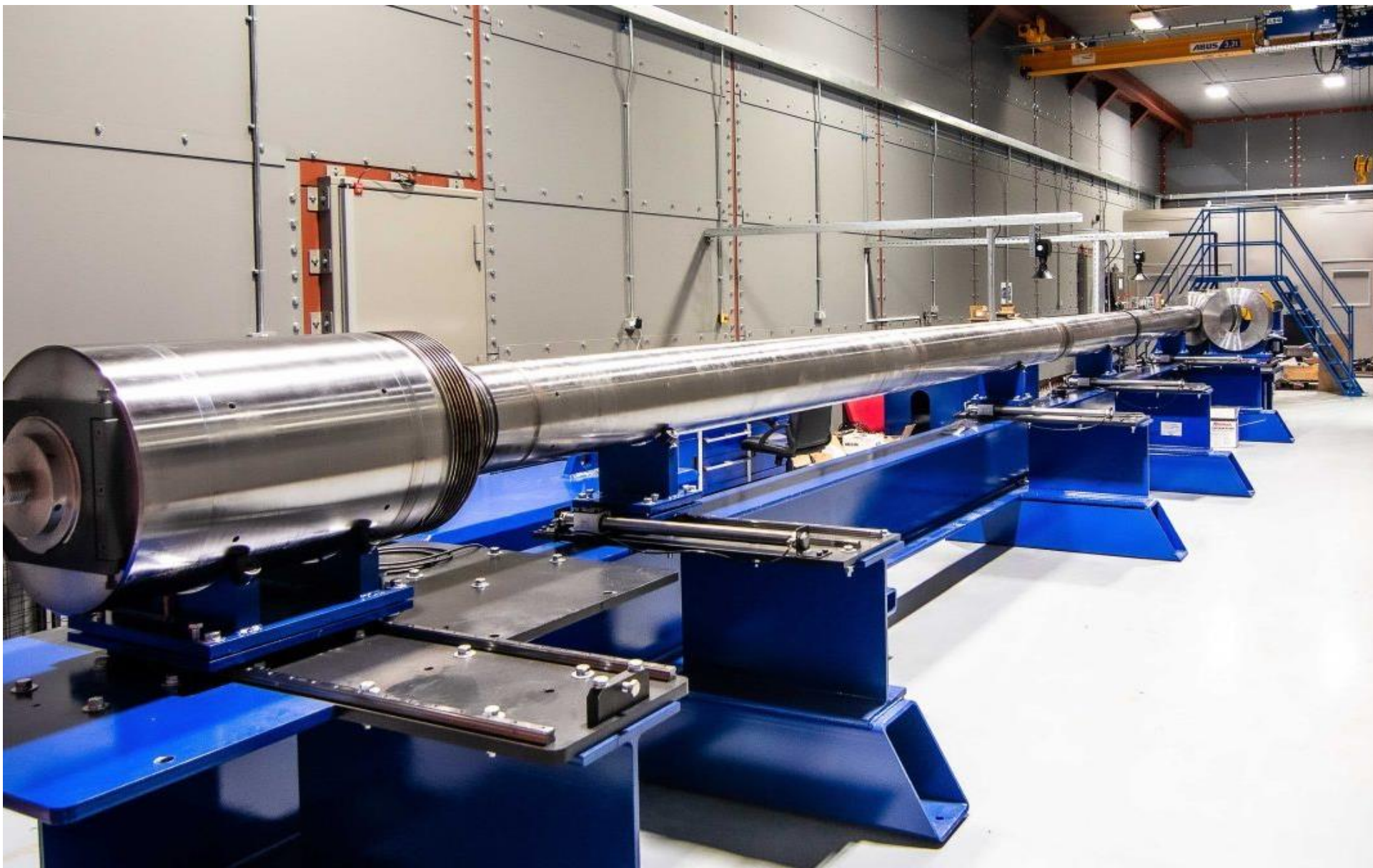
Abbildung 1: Beispiel eines Leichtgasbeschleunigers © First Light Fusion
