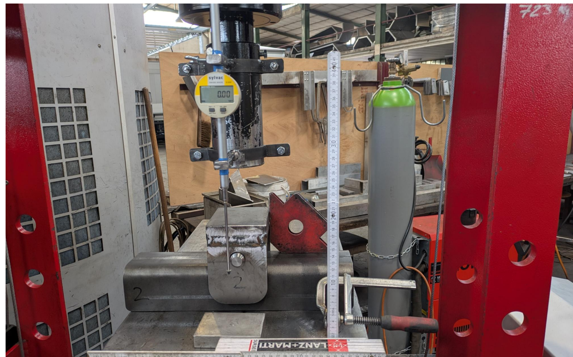
Abbildung 2: Prüfsituation der Untersuchung der Rollenlagerung
