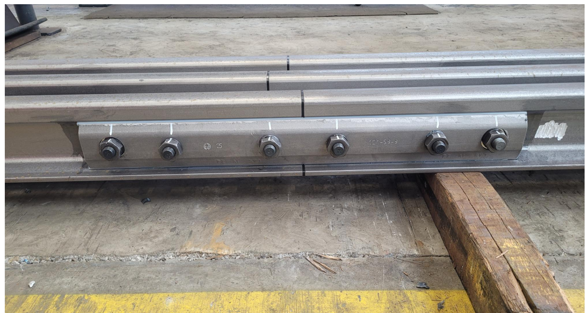
Abbildung 2: Fertiger Isolierstoss. Gewicht Lasche: 30 kg
