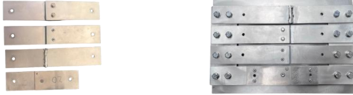
Abbildung 1: Proben für die thermische (links) und mechanisch-dynamische (rechts) Validierung
