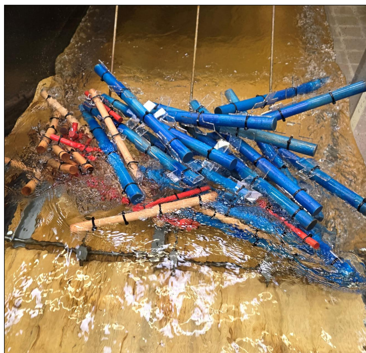
Abb. 5 Rechen mit s = 0.25\text{m} in Fließrichtung
