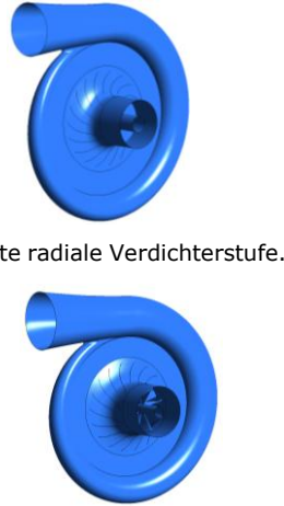
Abb. 3: Erste radiale Verdichterstufe.
