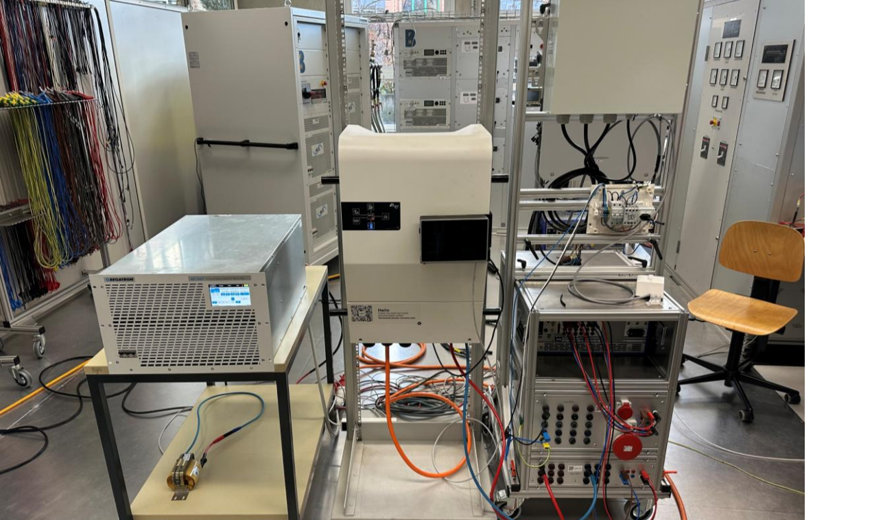
Messaufbau Laborversuche an Wechselrichter
