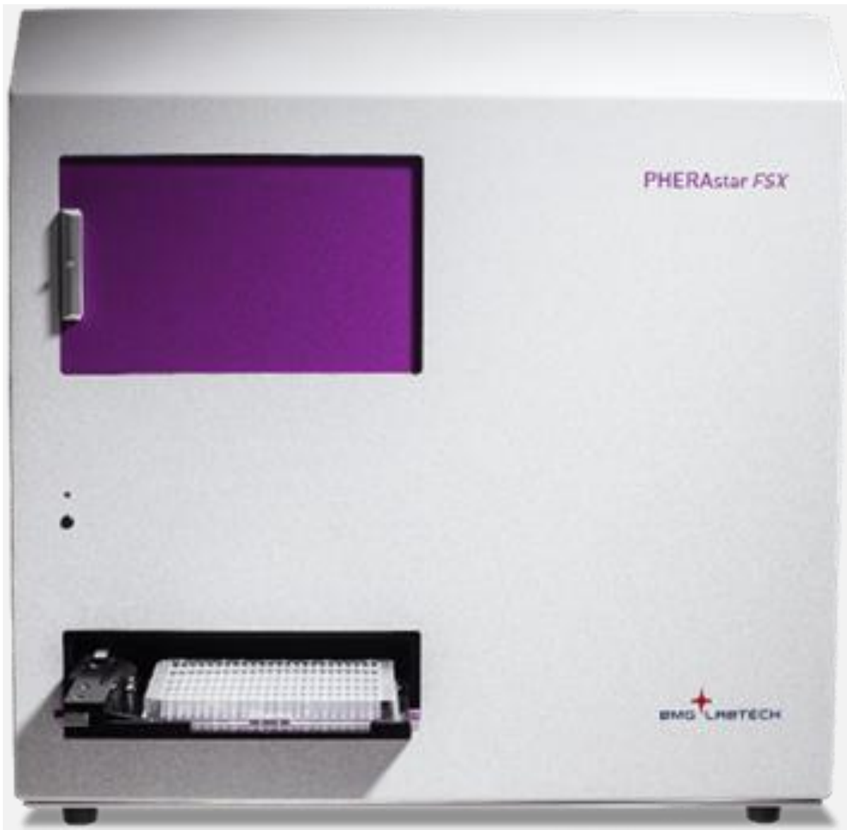
Abbildung 4: BMG PHERAstar FSX Plattenleser für die Kollagenpolymerisation sowie Absorptions- und Transmissionsmessungen (Quelle: https://www.bmglabtech.com/de/pherastar-fsx/ )
