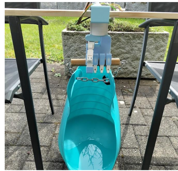
Abb. 3: Testaufbau des Traglastversuchs
