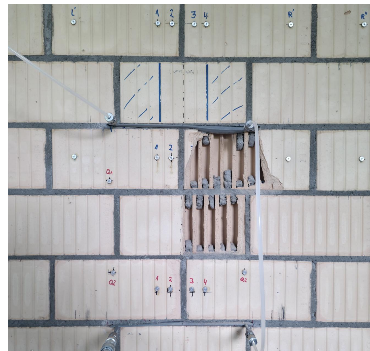
Abb. 3 Flat-Jack-Bruch bei 7.3N/mm²
