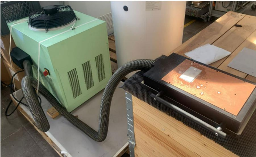
Abbildung 1: Bestehendes Gefrierspannsystem der Firma Triag AG
