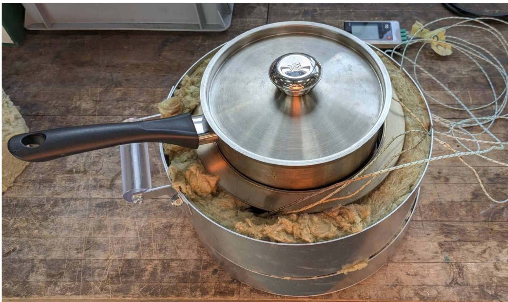
Abbildung 3: Versuchsaufbau zur Bestimmung der nutzbaren Wärmemenge
