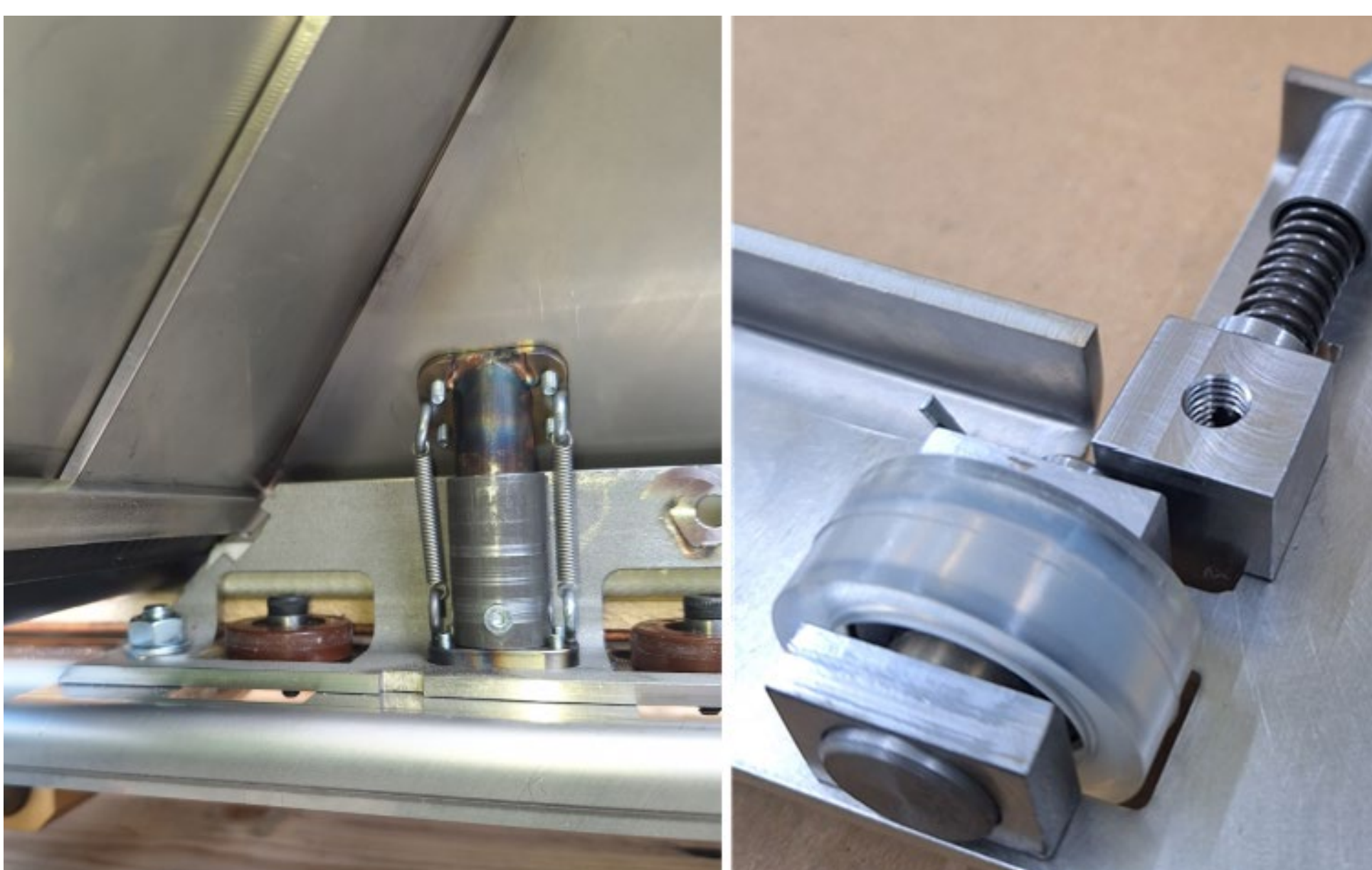
Abb. 3: Vertikal- und Horizontalfederrückstellung mit Führungsrollen
