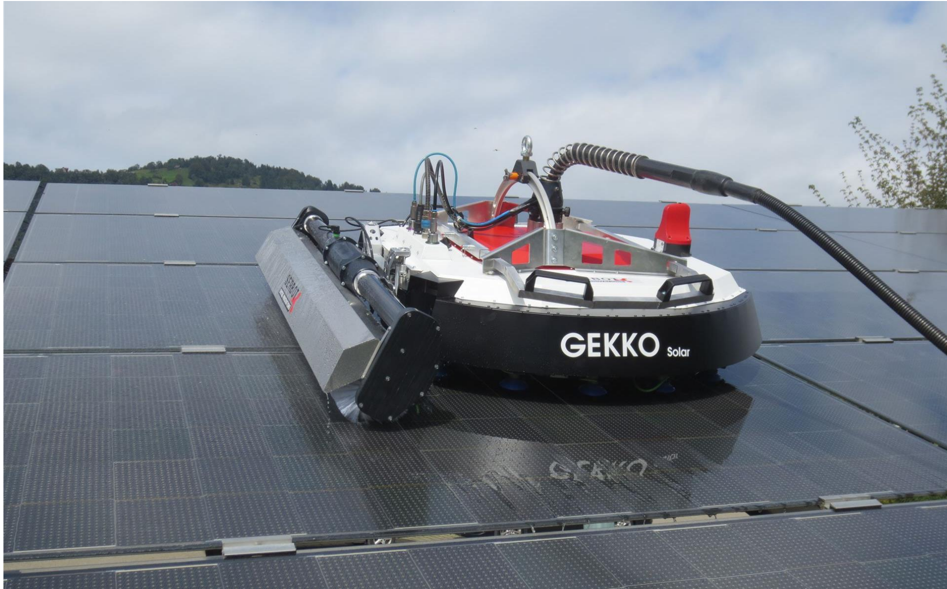
Abbildung 1: Gekko Solar, Reinigungsroboter
