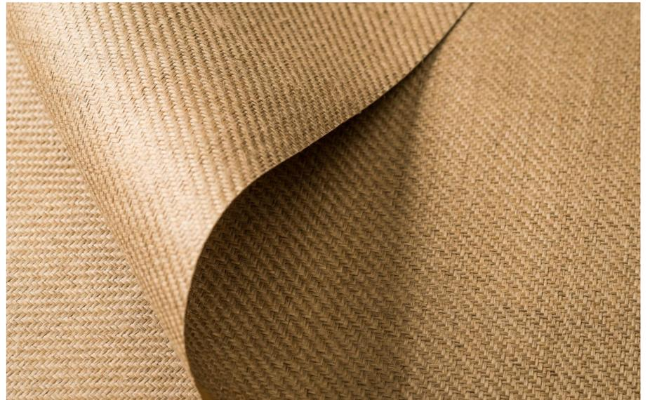
Abbildung 2: Flachsfaser Gewebematte, Amplitex Bcomp
