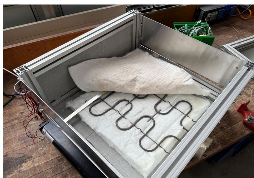
Heizung und Dämmung im Teststand
