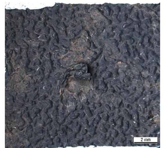
Schäden nach dem Fahrzeugversuch an einem grob genarbt Kunststoff
