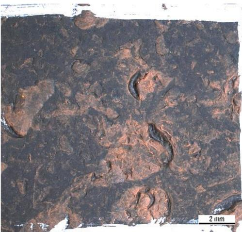
Schäden nach dem Fahrzeugversuch an einer glatten Kunststoffoberfläche
