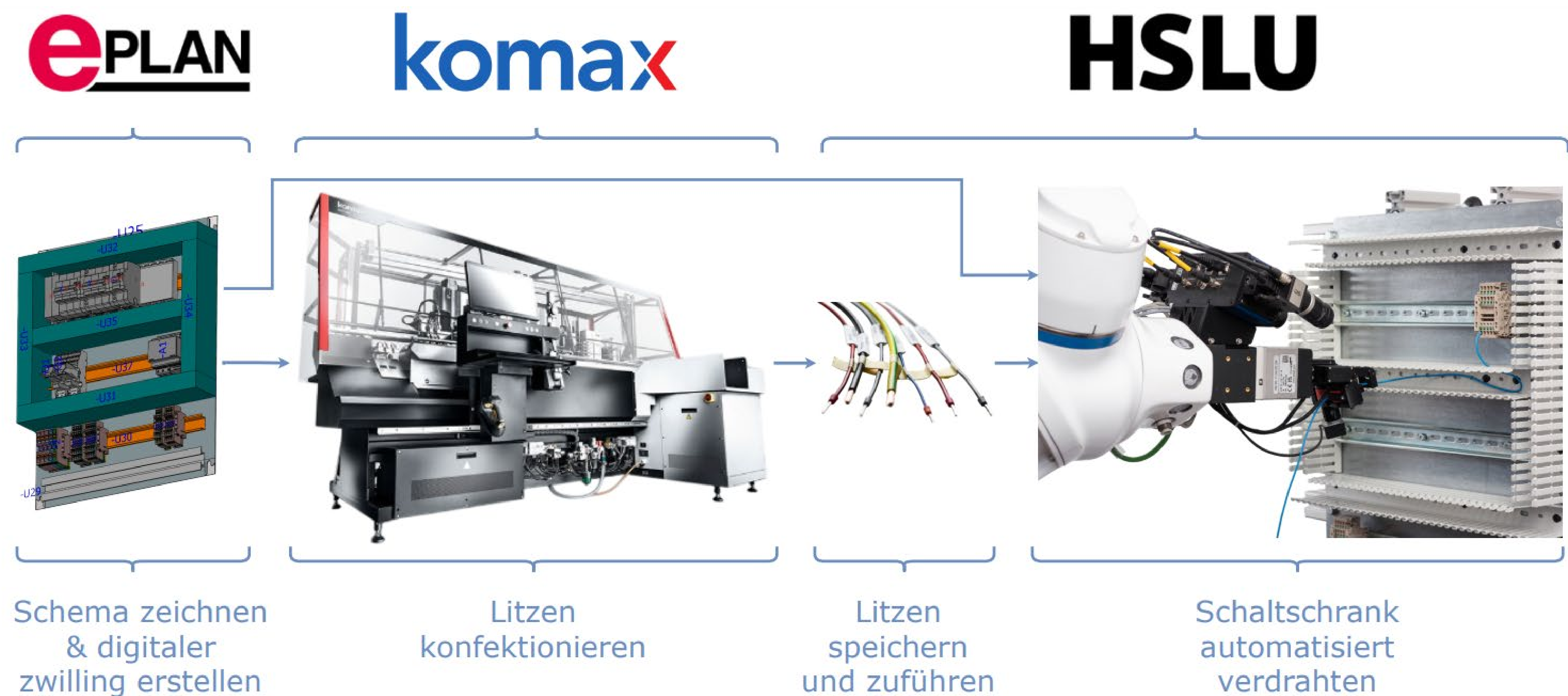
Abbildung 1: Übersicht des Workflows des automatisierten Verdrahtens
