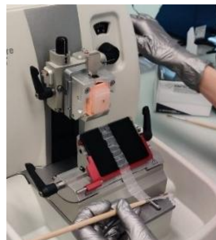
Abb. 6: Gewebeprobe wird mit einem Mikrotom in histol. Schnitte geschnitten (Müller, 2025).
