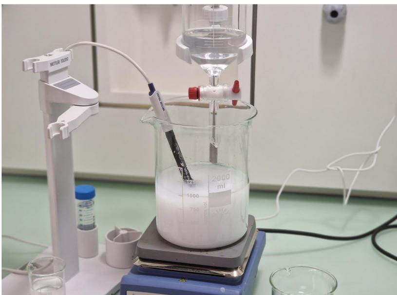
Aufbau der Titrationsvorrichtung für die nasschemische Fällung
