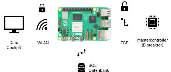
Abb. 2: Architekturkonzept der Steuerung
