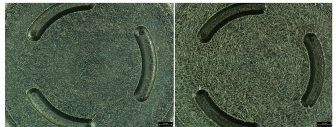
Abb. 3: Vergleich der Gravur hinsichtlich Herstellverfahren. Formgepresster Rotor (links) und spritzgegossener Rotor (rechts)
