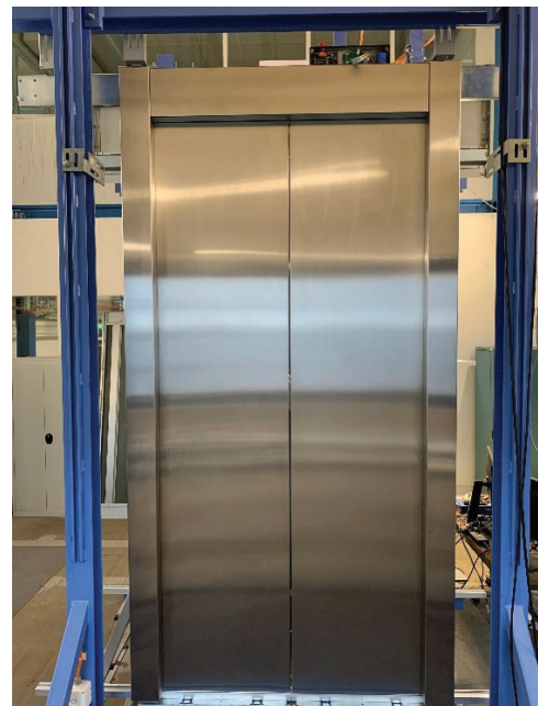
Abb. 1: Aufzugstüre an einem Prüfstand montiert
