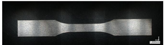
Abb. 2: Mikrozugprobe
