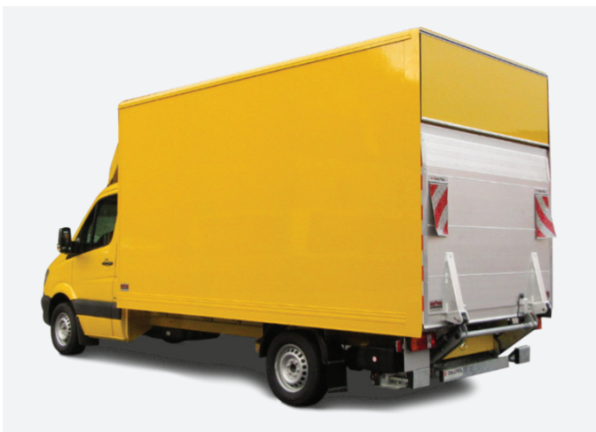
Abb. 1: Möbeltransport-Aufbau Typ HSAB der Ackermann Fahrzeugbau AG
