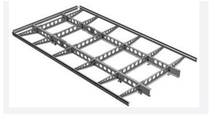
Abb. 2: CAD-Datei der Unterbaukonstruktion aus Aluminium
