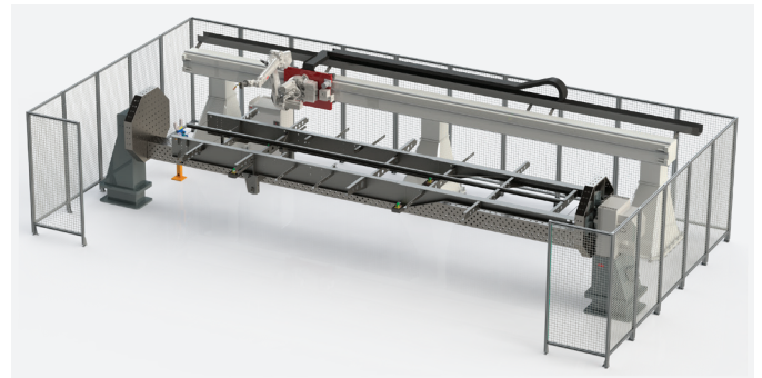
Abb. 2: Das Konzept der Roboterschweissanlage
