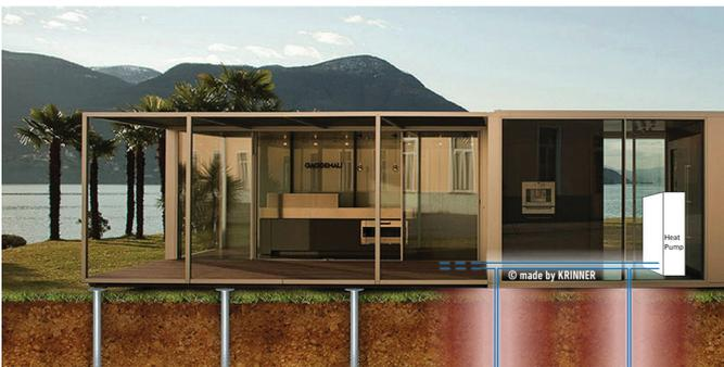
**Abb. 1:** Thermisch aktivierte Schraubfundamente mit integriertem Erdwärmesondenkreis
