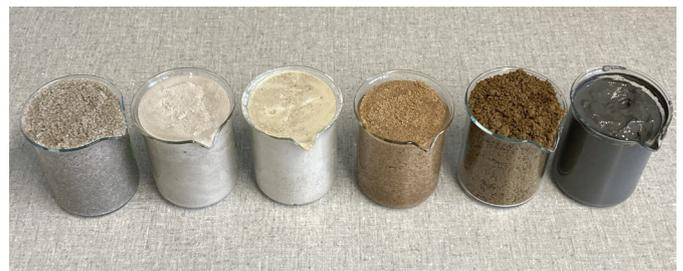
**Abb. 3:** Verschiedene Materialien, die auf ihre Eignung als Hinterfüllungsmaterial in den thermisch aktivierten Schraubfundamenten analysiert wurden
