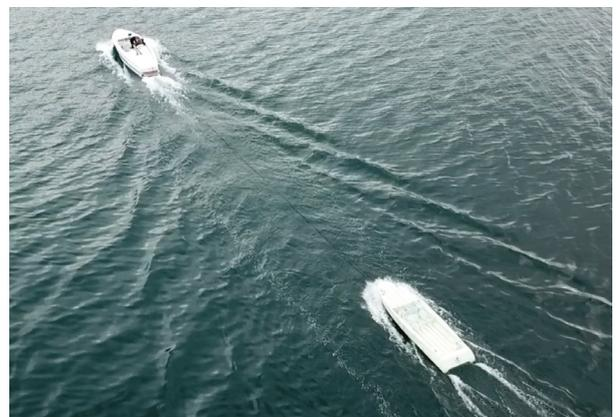
Abb. 2: P01 während dem Schleppversuch. Ein Kraftmessgerät wird am Ende des Seils montiert
