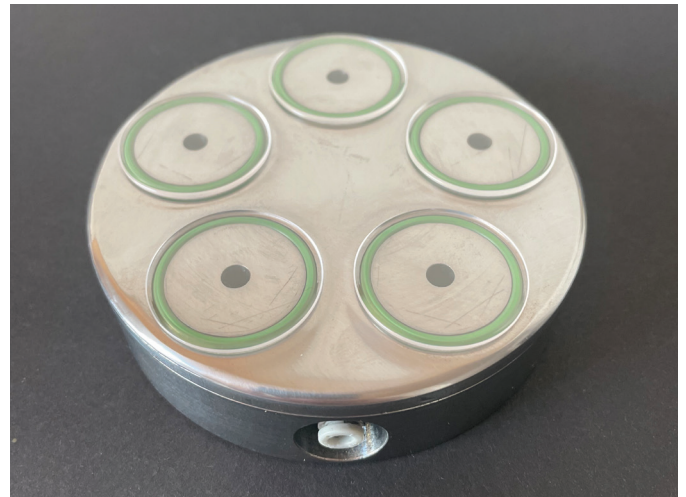
Abb. 2: Prototyp beim Spannen von Saphirgläsern
