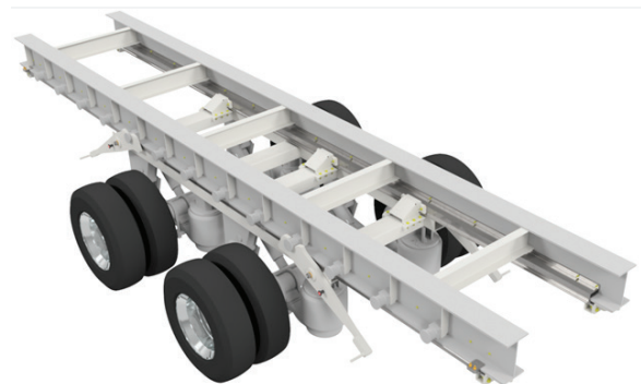
Abb. 3: Modell der verschiebbaren Achse
