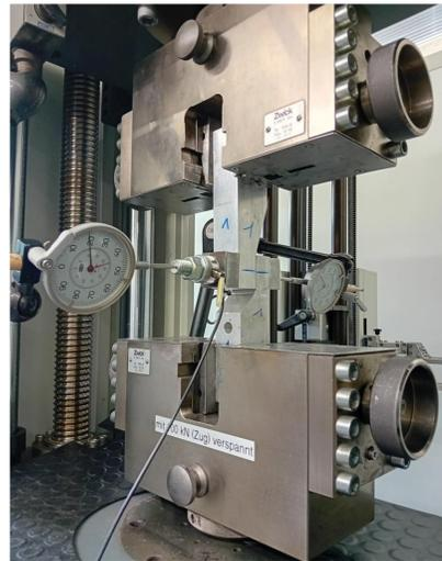
Abb. 3: Scherprüfung der Verbindungsteile
