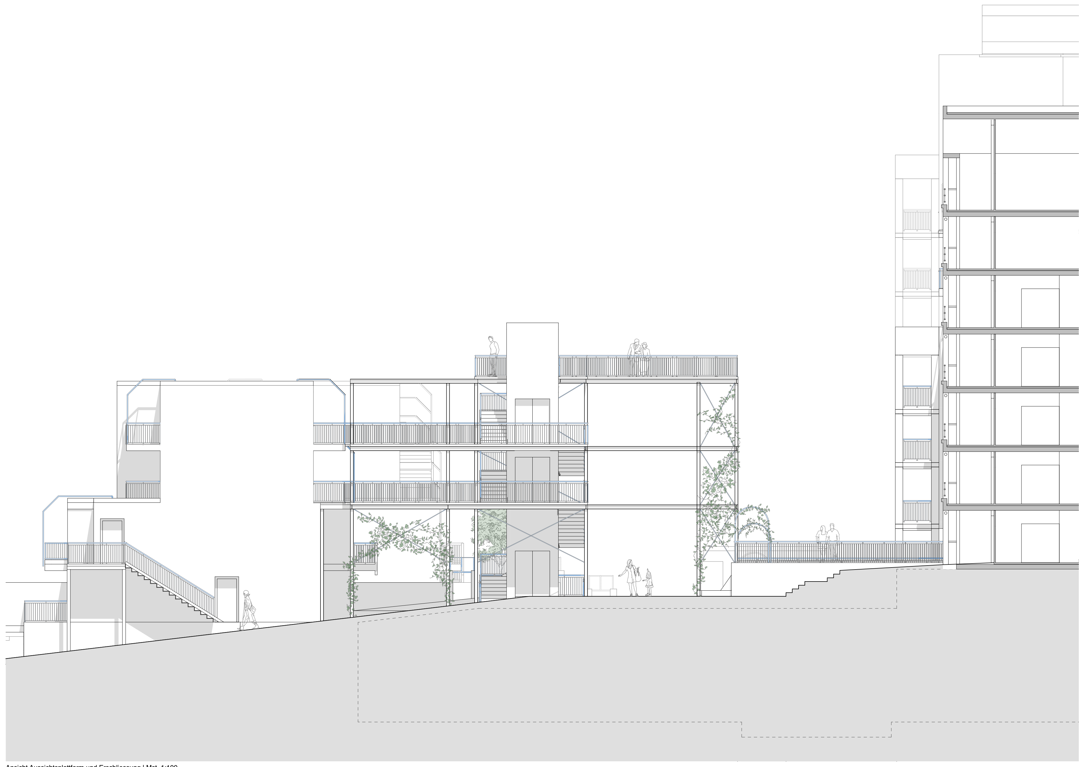
Ansicht Aussichtsplattform und Erschliessung | Mst. 1:100
