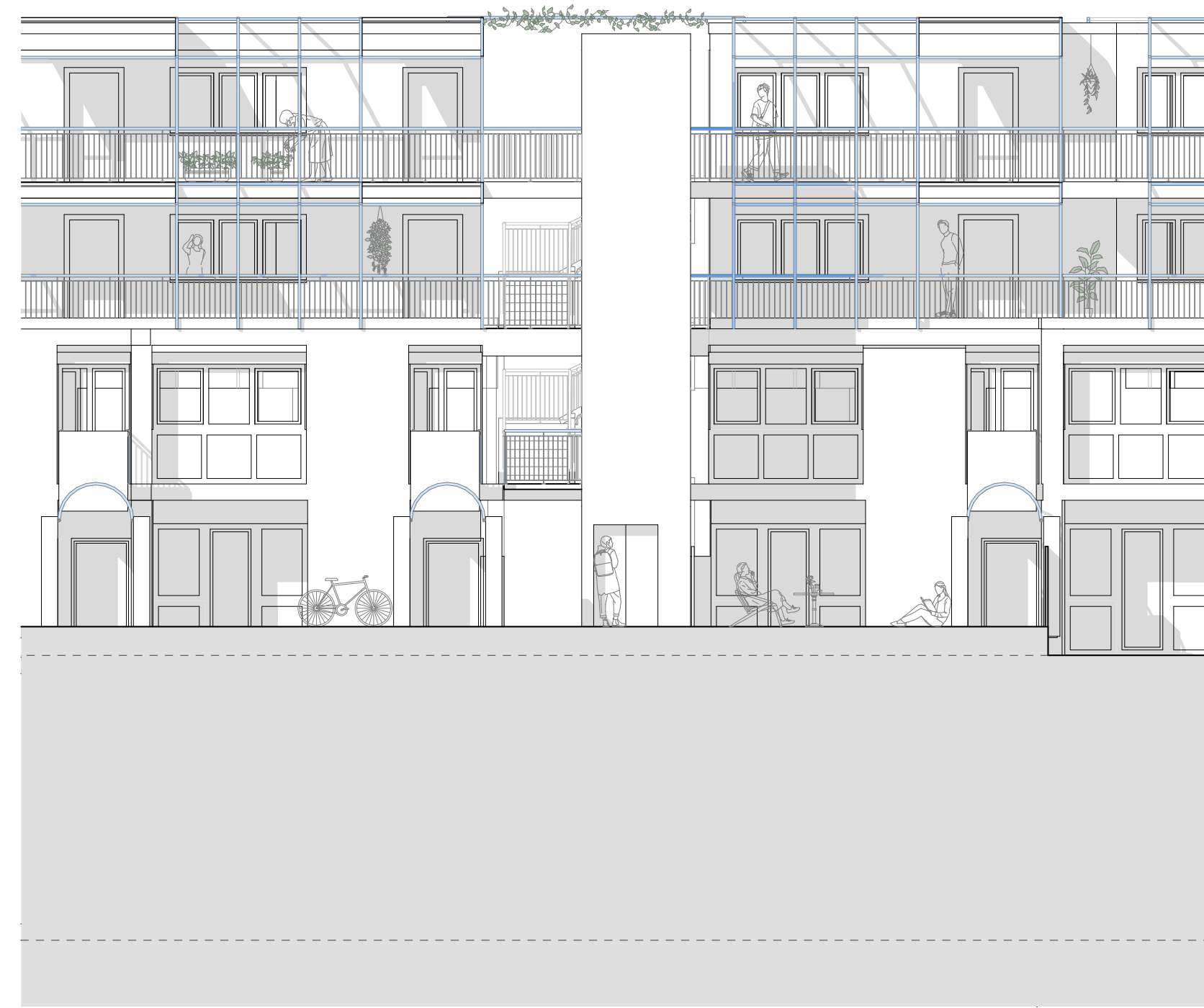
Ansicht Aufstockung und Erschließung | Mst. 1:100
