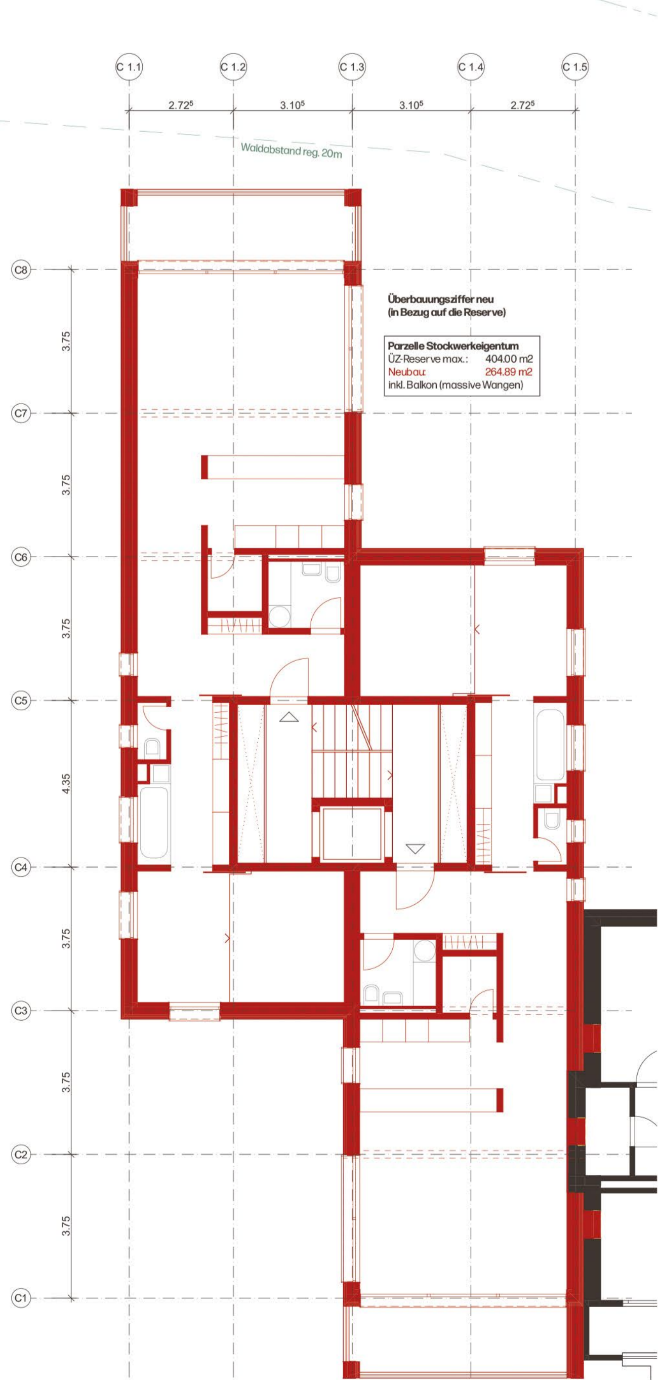
Konstruktionsraster Platzhaus | M 1:100
