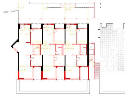
Bestand, Abruch, Neubau Erdgeschoss 1:200
