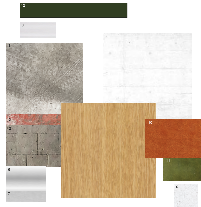
1- Bodenbelag Papier; Betonboden | 2- Asphaltplatten | 3- Stahlstiege rot | 4- Betonwand weiss gestrichen | 5- Innenarchitektonische Elemente: Sitzbank Holzturner aus Eiche und Podest Schlossdiele aus Eiche massiv | 6- Verkleidung Bar aus Chromstahl spiegellack | 7- Arbeitsfläche Bar aus Edelstahl gebürstet | 8- Akustikvorhang Deltacoustic von Création Baumann | 9- Tischplatte aus Quarzit | 10- Bezugsstoff Sitzbank Avalon orangebraun von Kvadrat | 11- Bezugsstoff Sessel grün Avalon von Kvadrat | 12- Deckenstruktur Beton grün gestrichen- Stützen ab 1,90 cm grün gestrichen
