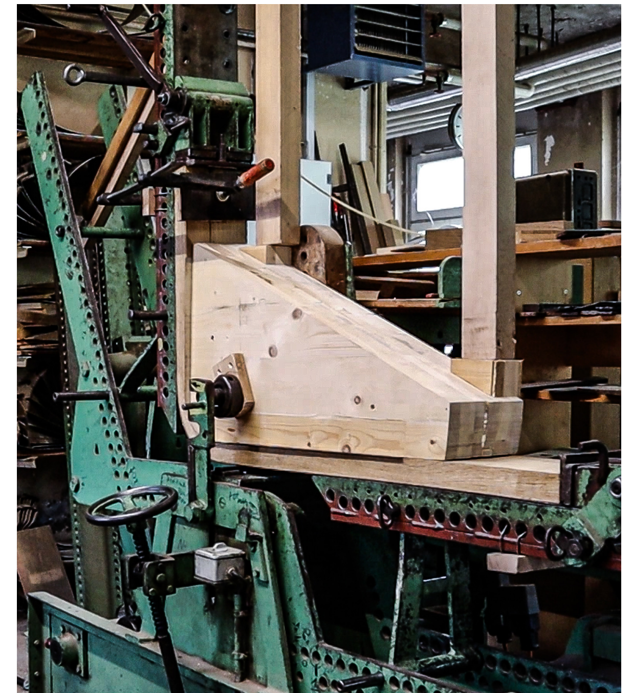
Teil des Ständers auf der Biegemaschine
