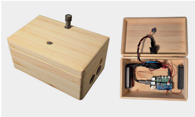
Abb. 1: Aussen- und Innenansicht – Lokaler Sprachassistent
