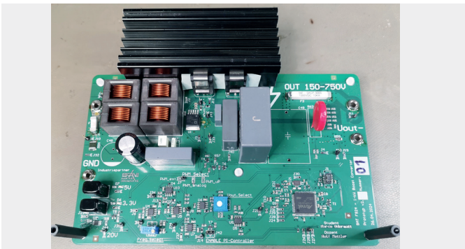
Abb. 2: Prototyp 2 – zusammengebaut und mit Kühlkörper
