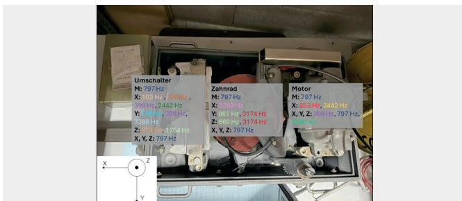
Abb. 4: Die Frequenzübersicht des Weichenantriebes zeigt sehr viele gemessene Frequenzen. Das Koordinatensystem zeigt die Ausrichtung des Beschleunigungssensors. M steht für das Mikrofon und X, Y und Z für die drei Achsen des Beschleunigungssensors. Durch die Einfärbung ist zu erkennen, dass ein paar Frequenzen mehrmals vorkommen.
