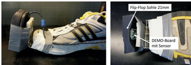
Abb. 2: Prototypen Aufbau für Machbarkeits-Analyse
