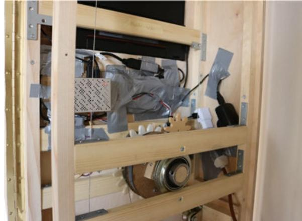
Abb. 60: Kurbelbox mit Raspberry PI und Verkabelung (Opanasenko, 2023)
