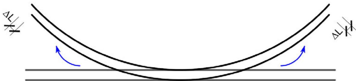
Abb. 43: Leistenverschiebung bei der Biegebeanspruchung (Opanasenko, 2023)
