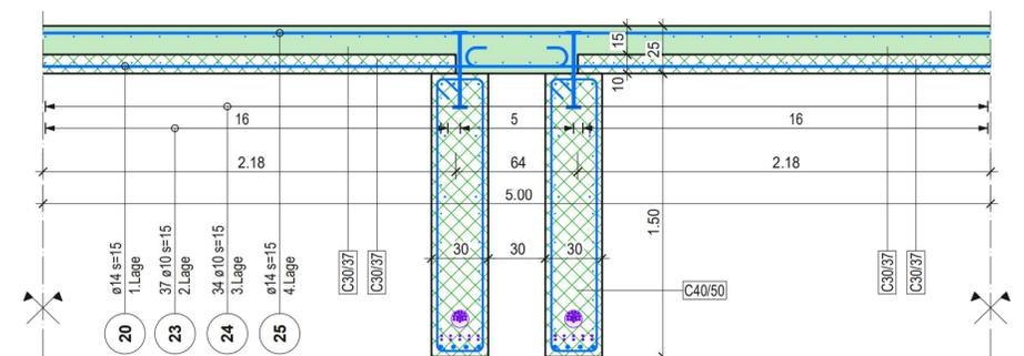
Abb. 7 Schalung und Deckenbewehrung - Querschnitt
