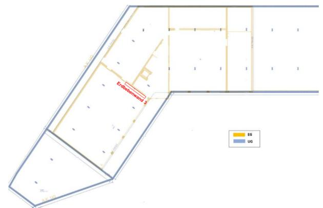
Abb. 4: Tragelemente im Untergeschoss und Erdgeschoss
