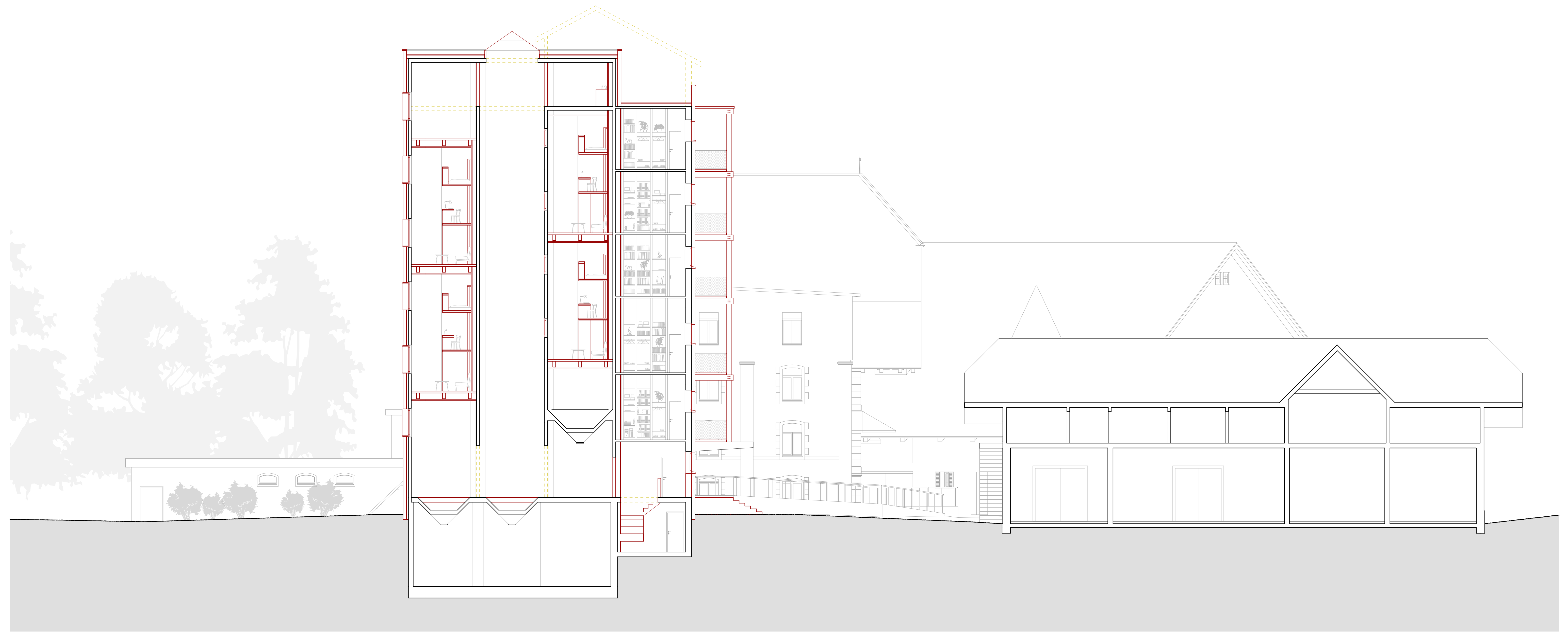
Querschnitt durch das Silo 1:100 — 2m —
