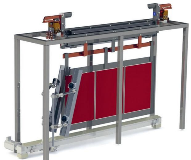
Abb. 3: Trocknungsstation ohne Deckelsystem, Abdeckungen und Seitenkanalverdichter
