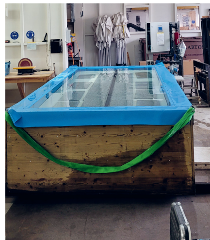
Abb. 3: Hubboden im Funktionsmuster eingebaut und 40 cm abgesenkt
