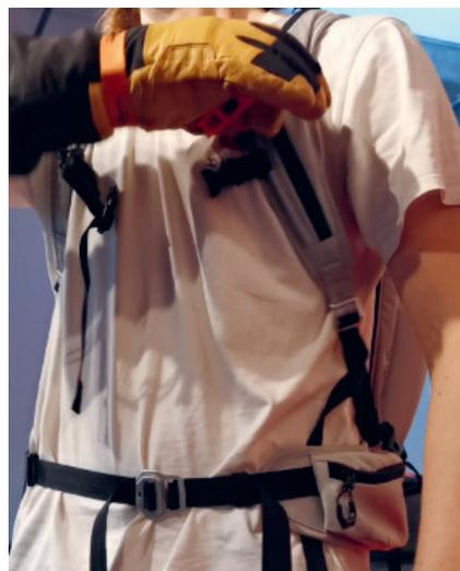
Abb. 3: Proband Nr. 6 bei der stehenden Auslösung der Griffereinheit am aktuellen System Mammut «R.A.S. 3.0»
